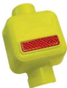
Articolo 780/b COPRIGIUNTO STANDARD Realizzato in polipropilene per ponteggio tradizionale con catarifrangente rosso. Confezione da 90 pezzi.
