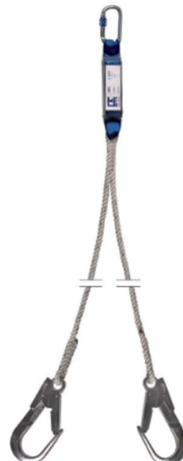
Articolo 045/n ASSORBITORE DI ENER- GIA A NASTRO A "Y" Con 1 moschettone ovale con ghiera in acciaio (Articolo 09) e 2 moschettoni con chiusura a doppia leva in lega (Articolo 013). Conforme alla Norma EN 355.
