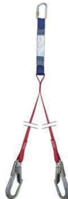
Articolo 045/n ASSORBITORE DI ENER- GIA A NASTRO A "Y" Con 1 moschettone ovale con ghiera in acciaio (Articolo 09) e 2 moschettoni con chiusura a doppia leva in lega (Articolo 013). Conforme alla Norma EN 355.
